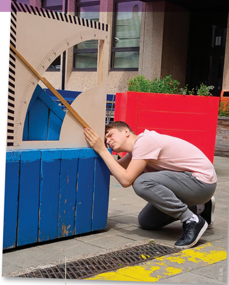
Mesure d'une hauteur depuis la cour de l'école avec le carré géométrique.
