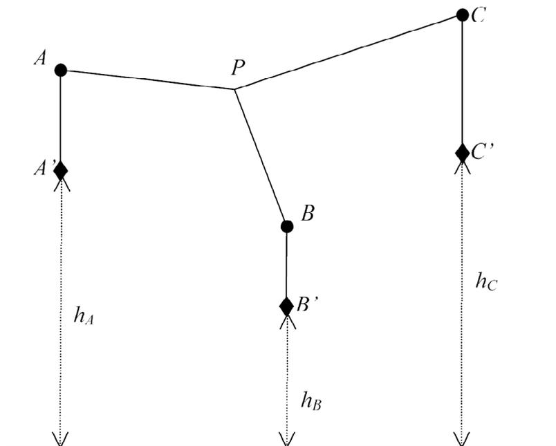
A l'équilibre, on constate que les angles  $\widehat{APB}$ ,  $\widehat{BPC}$  et  $\widehat{APC}$  mesurent tous  $120^\circ$ .  $P$  est donc le point de Fermat du triangle  $ABC$ . Pour en faire la preuve, nous allons nous baser sur le principe de DIRICHLET qui affirme qu'à l'équilibre, l'énergie potentielle d'un système mécanique est minimale.
