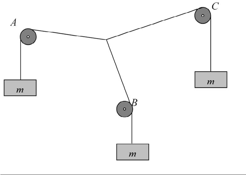
Aux sommets  $A$ ,  $B$  et  $C$  du triangle, plaçons des poulies qui supportent des masses égales suspendues par un fil. Les trois fils sont reliés en  $P$  comme l'indique le schéma :
