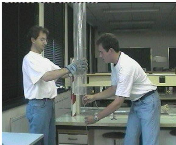
Fig. 2 : Les grilles chauffées au rouge et montées sur la tige filetée sont peu à peu introduites dans le tube. A environ un quart de la longueur du tube, un son puissant se fait entendre.
