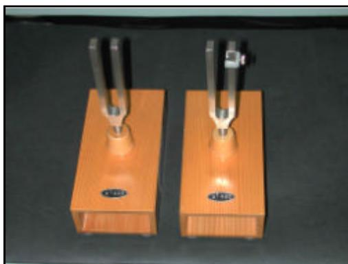
Fig. 1 : Deux diapasons identiques dont l'un est muni d'un cavalier permettent de produire le phénomène de battement.
