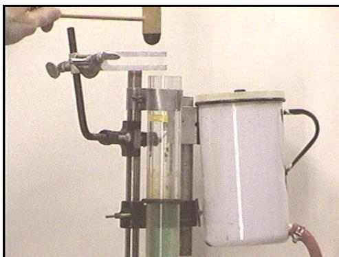
Fig. 2 : Etablissement d'une onde stationnaire à partir de la résonance du diapason.
