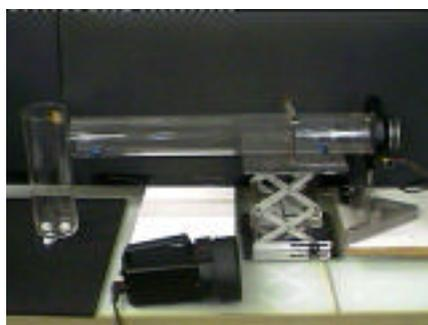
Fig.1 : Photo du montage expérimental. Nous avons relié le haut-parleur (à droite) au verre (à gauche) par un tube en plexiglas « accordé » à  $3\lambda/4$ . Le verre est installé sur 3 petits supports en frigolite.
