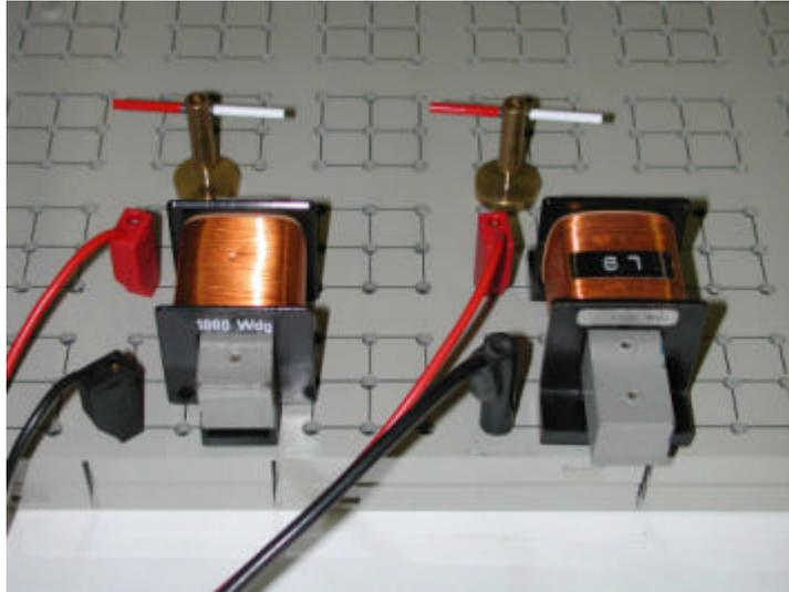
Fig. 2 : Détail des boussoles utilisées dans l'expérience. Les bobines sont alimentées par un courant alternatif et génèrent le champ oscillant  $B_1$  orthogonal au champ  $B_0$ .
