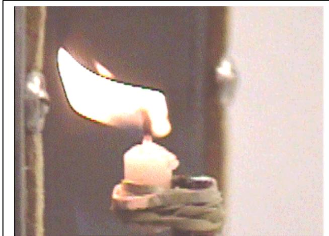
*Fig. 4 : Mouvement oscillatoire de la flamme dû aux ondes sonores.*
