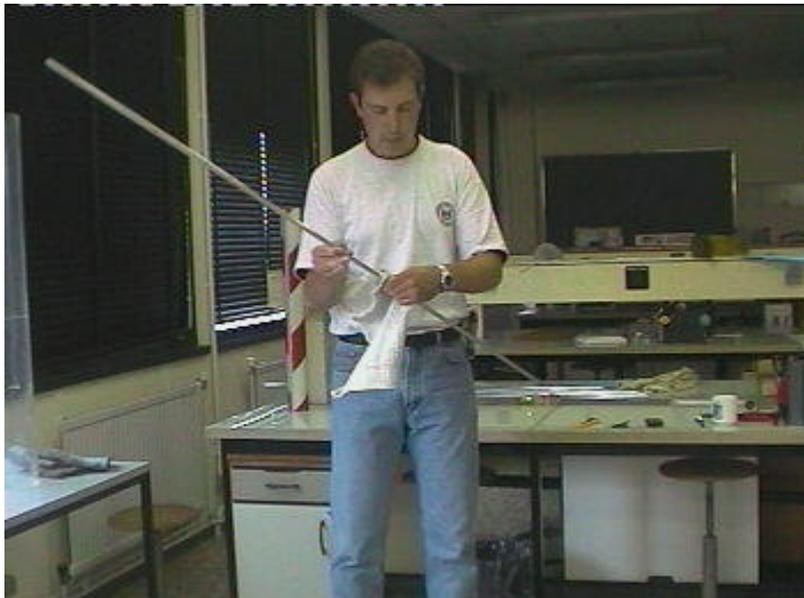
Fig. 1 : En maintenant la tige à mi-longueur, on produit la note fondamentale.
