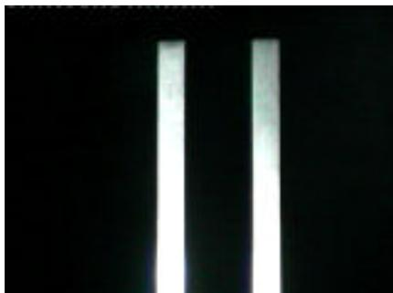
Fig. 3 : Avec un stroboscope, on peut mettre en évidence le mouvement vibratoire des deux branches d'un diapason.
