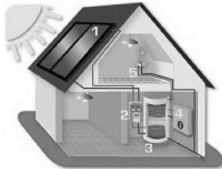
1. Capteur solaire thermique – 2. Système de circulation et de régulation –
