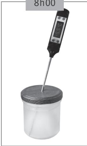
Au début de l'expérience, il n'y a que de la glace dans le pot. Le thermomètre affiche  $-5,5\text{ }^{\circ}\text{C}$ .
